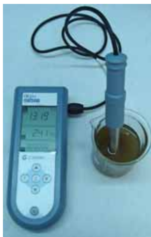
A medida da condutividade faise introducindo o electrodo no xurro diluído con auga na proporción 1:9
