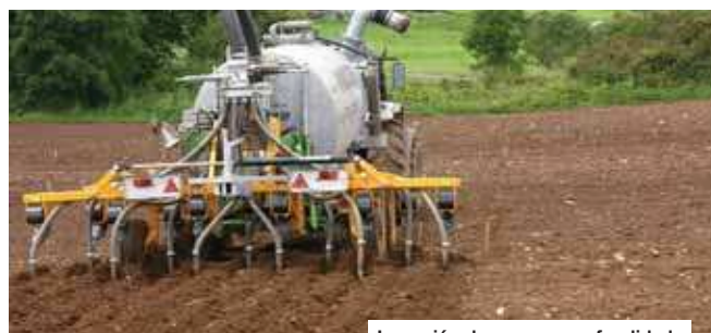
Inxección do xurro en profundidade
